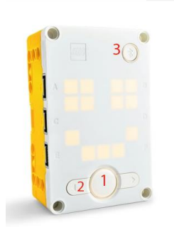
Kuva 4: Virta-, valinta- ja bluetooth-painikkeet
