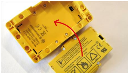
Kuva 6: Akun asettaminen paikalleen
