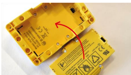
Joonis 6: Kuidas akut sisestada
