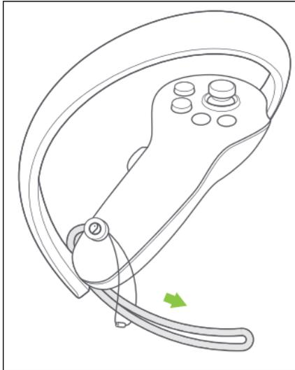
Passa o Controller Lanyard através da string como mostrado e bloqueie no final do Controller.
