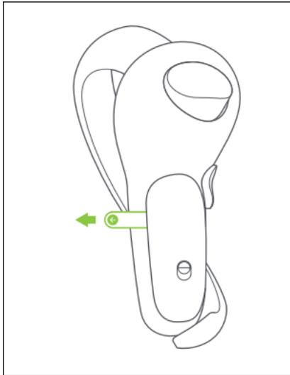
Você deve remover a guia de segurança de cada controlador, o que impede que as baterias sejam conectadas corretamente aos controles.
