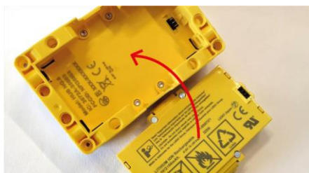
Figuur 6: Hoe de batterij te plaatsen
